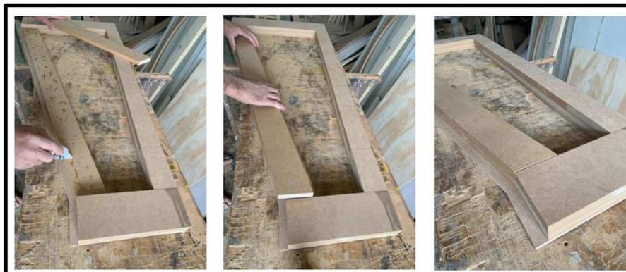
**Figura 33** – Unindo as duas camadas de preenchimento através da colagem.
