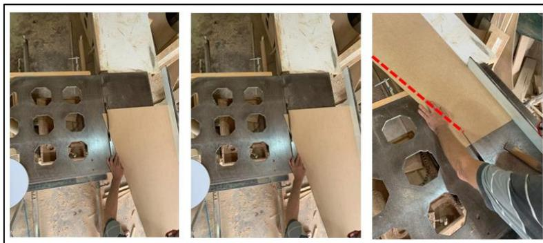
**Figura 06** – Recorte das pontas da peça de MDF seguindo a linha tracejada em vermelho.
