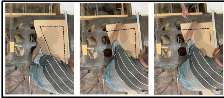
**Figura 19** – Recorte interno da face lateral da rampa reta, em cima do desenho do trapézio traçado anteriormente.
