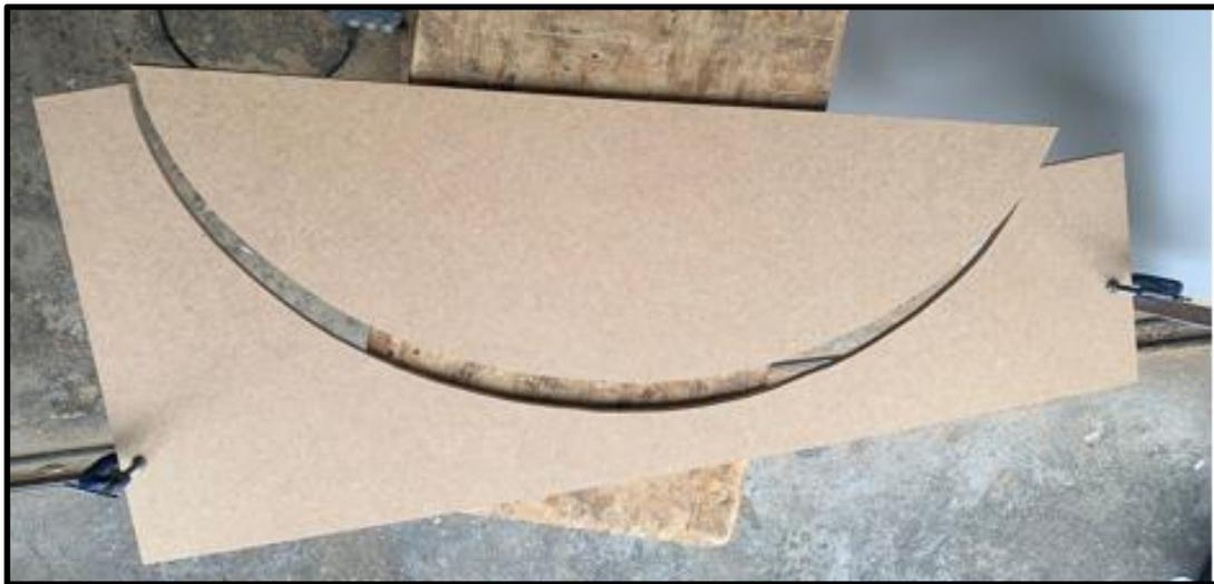
**Figura 16** - Faces laterais da rampa curva após recorte.
