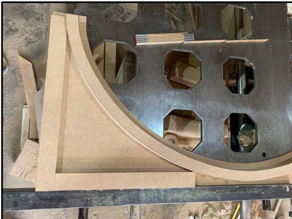
**Figura 29** – Fixação das peças laterais e da base na extremidade superior da rampa curva.
