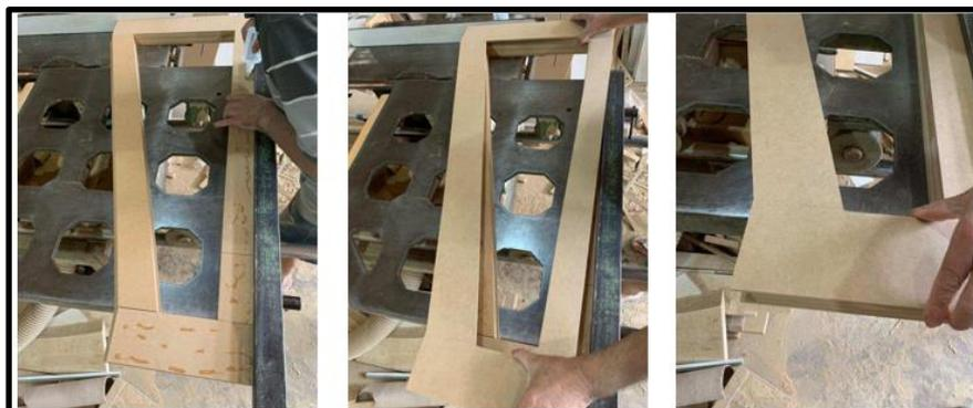
**Figura 34** – Fixação da face lateral de 6 mm nas estruturas de preenchimento.
