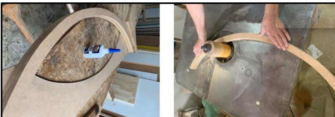
**Figura 27** –Lixamento para retirada de imperfeições do preenchimento curvo.
