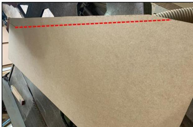
**Figura 07** – Peça de MDF após o recorte das pontas.
