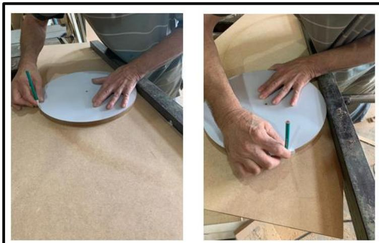
**Figura 13** – Traçado do arco de cicloide com o auxílio do círculo de madeira.
