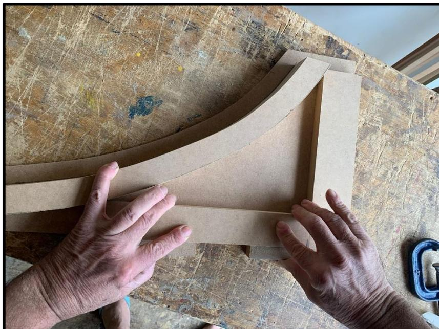
**Figura 30** – Fixação das peças laterais e da base na extremidade inferior da rampa curva.
