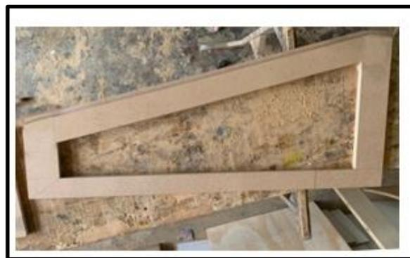
**Figura 21** – Face lateral da rampa reta após conclusão dos recortes internos.
